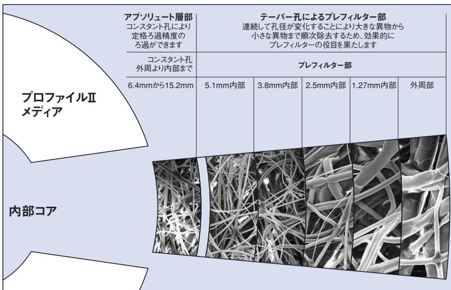
代表的“プロファイルII”メディアのテーパ孔部、コンスタント孔部の電子顕微鏡写真（300倍）
