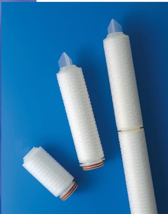
疎水性PTFEメンブレンフィルター“エンフロンPFR”は、気体滅菌に永年の実績を持つ“エンフロン”の次世代製品として開発されたフィルターです。流量特性、耐熱性、スチーム滅菌時の耐逆差圧強度が、“エンフロン”より大幅に改善されています。したがって、経済性にも優れており、お客様の高度なご要望に十分お応えできるフィルターです。
